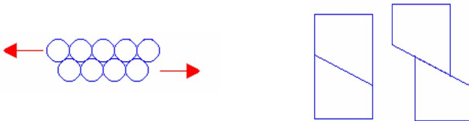
Si se tiene en cuenta la energía necesaria para que se produzca el desplazamiento, es preciso tener en cuenta que en la red cristalina los átomos se encuentran en posiciones de mínima energía. El deslizamiento exige que un átomo (el 1 en la figura) pase de una posición de equilibrio a la siguiente (de 1 a 1'), y esto para todos los átomos del plano A considerado.
