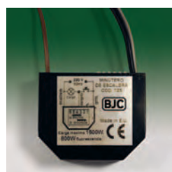
Interruptor temporizado electrónico regulable 230 V 50-60 Hz Máx 1500 W incandescencia 800 fluorescencia Regulable de 20s a 20 min Conexión 3 hilos Para instalar en cajas de empalme o derivación
