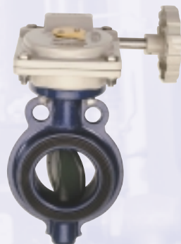
Figura 220 - (2) Válvula de mariposa tipo Wafer, con reductor Gama 2" - 12" (50 - 300 mm)
