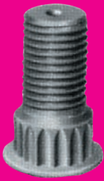
CONCAVIDAD AHUECADA EN ESPÁRRAGOS
