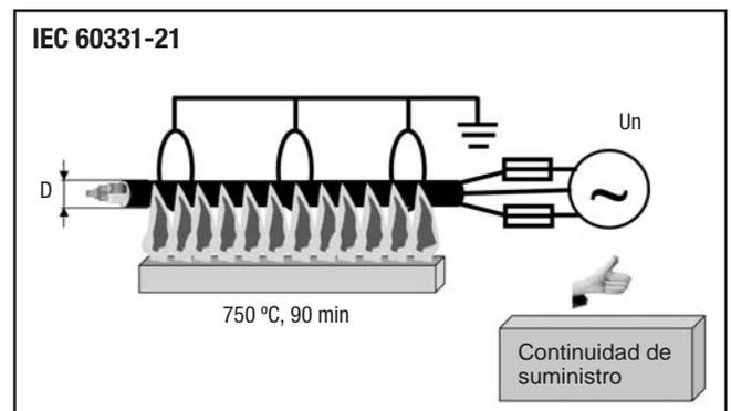
La resistencia al fuego trata de poner de manifiesto la aptitud del cable para dar servicio en condiciones extremas de un incendio. Los cables resistentes al fuego están destinados a aquellos servicios que se pretende no dejen de funcionar en un eventual siniestro con fuego (servicios de seguridad, servicios indispensables...).
