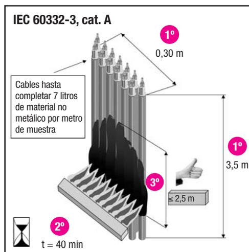
Los cables suelen agruparse en las canalizaciones lo que lleva a la necesidad de comprobar el comportamiento frente al fuego en grupo. En el ensayo de no propagación del incendio, (IEC 60332-3, categoría A) se agrupan muestras de 3,5 m de una determinada sección hasta completar 7 litros de material no metálico por metro de muestra. Se someten a las acción de las llamas durante 40 minutos y si la longitud final afectada por el fuego es menor de 2,5 m se considera el ensayo superado.
