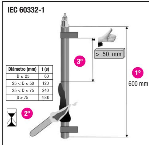
El ensayo de no propagación de la llama (IEC 60332-1) consiste en comprobar la ignifugación de una muestra única de cable en posición vertical. En función del diámetro exterior del cable se aplica la llama entre 1 y 8 minutos. El ensayo se considera superado si el cable no es afectado por el fuego más allá de los 5 últimos cm. Además se limita también la propagación hacia abajo del fuego.
