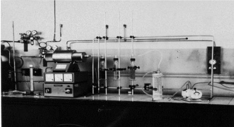
Con estos dos ensayos similares se demuestra que el cable ensayado es libre de halógenos (no emite HCl ni otros compuestos halogenados en su combustión) y los gases emitidos son de muy baja corrosividad con objeto de proteger a las personas y los bienes en caso de incendio.
