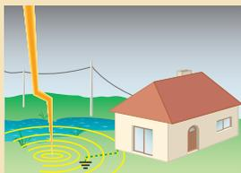
Las sobretensiones de origen atmosférico producidas por impactos indirectos de rayos, y las de origen no atmosférico como las provocadas por maniobras en la red eléctrica, son modelados por la forma de onda 8/20  $\mu$ s.
