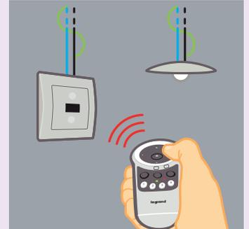
Receptor infrarrojos incluido, para el control mediante mandos móviles
