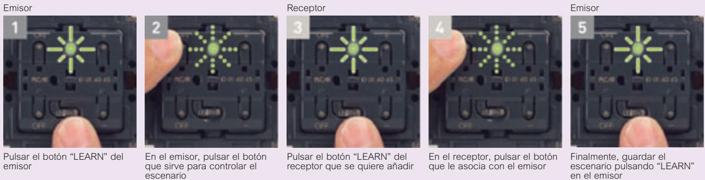
Los mecanismos memorizan la función al pulsar una tecla, asimilando lo necesario una sola vez y repitiéndolo indefinidamente. Así, para conectar más de un receptor a un emisor, repita los pasos 3 y 4 para cada receptor antes de guardar el escenario en el emisor. De esta forma, conseguirá que por ejemplo un interesenario en la entrada controle la iluminación del vestíbulo y del salón y las persianas de la planta baja, todo al mismo tiempo.
