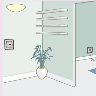
Mecanismo receptor cableado a la carga sustituyendo a un interruptor tradicional
