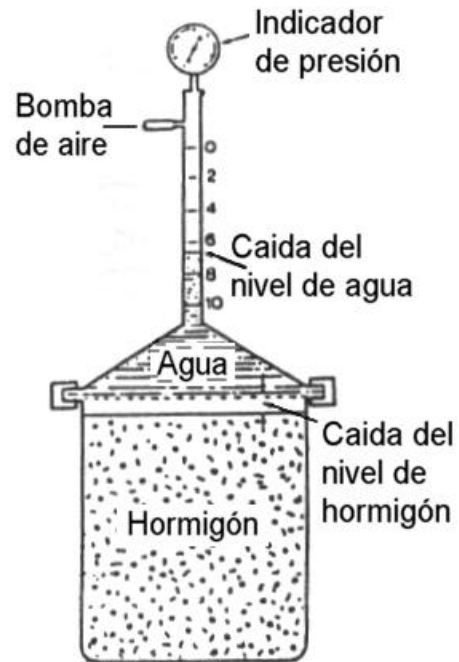
Figura 10. Medidor de aire por presión.
