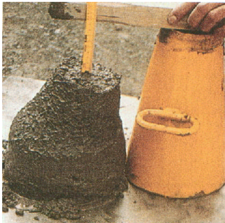
Figura 17. Medición del Asentamiento de Cono
