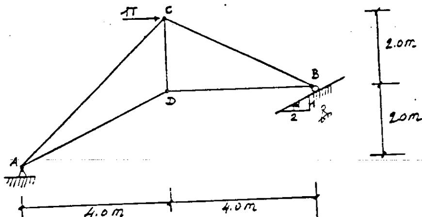
Obtener el desplazamiento vertical del nudo D de la estructura representada en la figura, por aplicación del método de los Trabajos virtuales.
