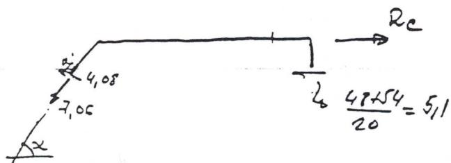
$$\begin{aligned} R_C &= 7,06 \operatorname{sen} \alpha + 4,08 \operatorname{sen} \alpha + 5,1 = \\ &= 7,06 \times 0,6 + 4,08 \times 0,8 + 5,1 = \\ &= 12,6 \end{aligned}$$
