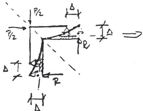
Como el nodo central no gira, luego el problema se reduce al de una viga apoyada apoyada, con un desplazamiento delta en el apoyo.
