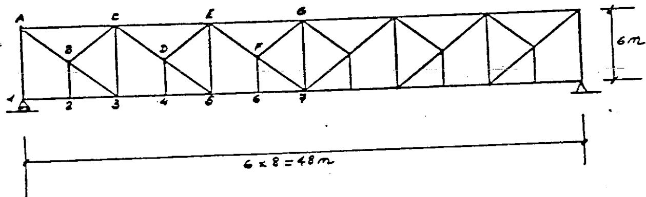
Calcular las LINEAS DE INFLUENCIA de las reacciones en A y C , y esfuerzo de la barra DF , cuando una carga unidad recorre el cordón inferior.
