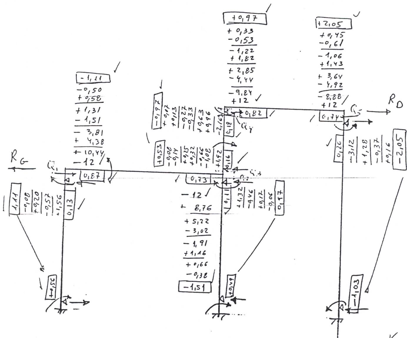
$$R_G = +Q_1 + Q_2 + Q_3 \approx +\frac{1,11 + 0,56}{3} + \frac{0,49 + 0,97}{3} + \frac{0,97 - 0,53}{2} = 1,26 \text{ m} = R_G$$
