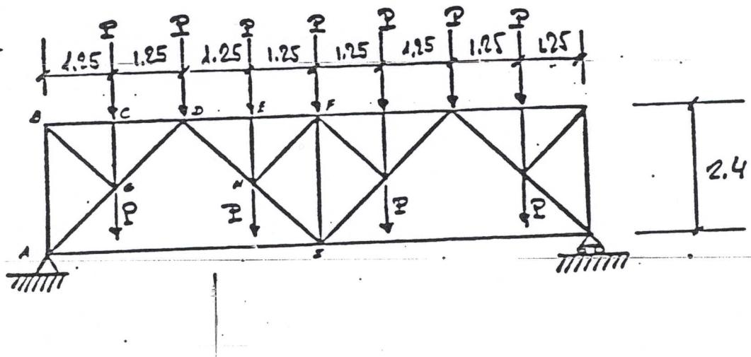
Para poder aplicar el Principio será necesario aplicar el Ritter para calcular el valor de las esfuerzos en los barnos del cordón superior, mediante un corte como el que se indica.
