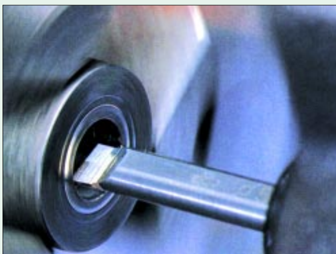
Herramientas BNBB para ranurado de agujeros hasta diámetro 3,5 mm en piezas templadas.
