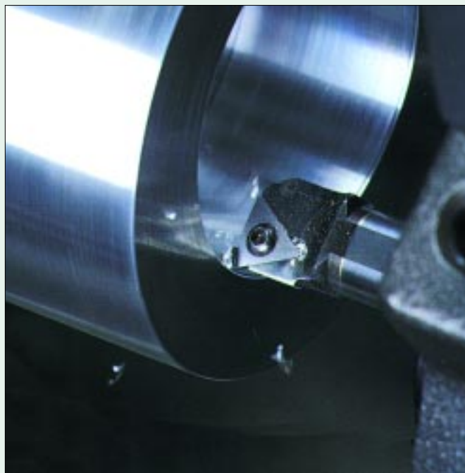
Torneado interior con la nueva plaquita PCD "Break Master"
