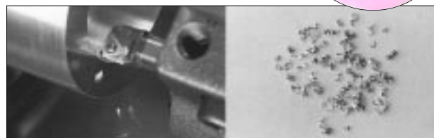
Excelente control de viruta con la nueva plaquita rompevirutas
