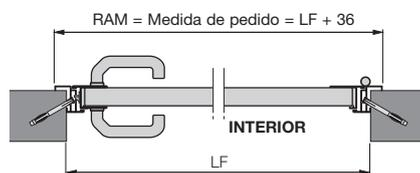
Puerta peatonal lateral de acero. Montaje detrás del hueco
