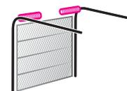
Guías horizontales con muelle trasero (L) con técnica de muelle de torsión
