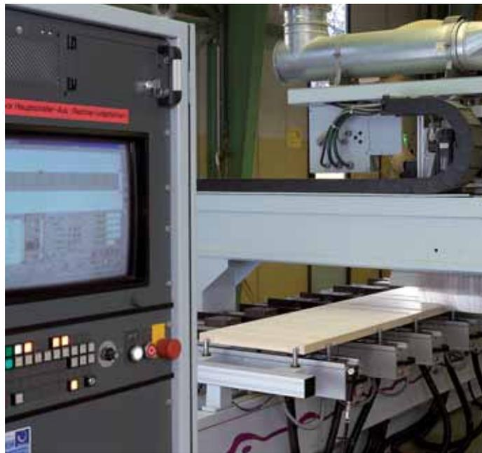
Una fresadora de precisión controlada por ordenador transfiere su dibujo con una precisión milimétrica al panel de madera de la puerta.
