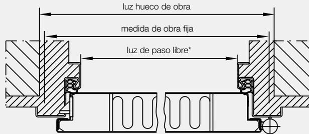
\* El ancho de la luz de paso libre con un ángulo de apertura de 90°, sin tener en cuenta manillas ni tiradores, se reduce en 2 mm.
