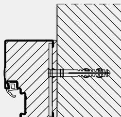
Montaje con tacos a través de la superficie interior del cerco
