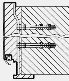
Mampostería vista u hormigón visto montaje con tacos a través de la superficie interior del cerco para MW desde 205 mm
