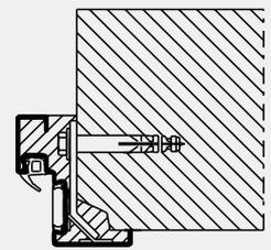
Montaje en mampostería vista u hormigón visto bridas de montaje para montaje cubierto
