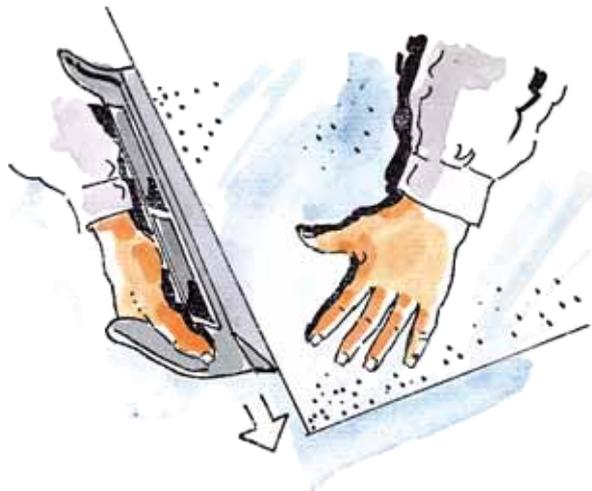
Los paneles de Trillaje y los Transformados con Aislante, se cortarán con serrucho, salvo que en éstas últimas el espesor del aislante sea muy pequeño.
