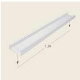
Debe anclarlas a los perfiles metálicos que recorren el interior de los techos **PLADUR®**. La separación de anclajes en una misma línea de perfil será de al menos 1,20 m.
