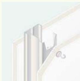
1. Localice los perfiles verticales del tabique y realice el anclaje directamente sobre ellos, mediante tacos tipo paraguas o similar.
