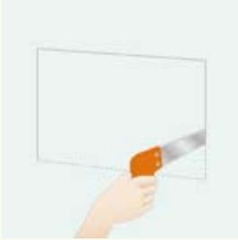
1. Con ayuda de una sierra de calar abra una apertura en la pared **PLADUR®** que vaya del eje de un perfil vertical hasta el eje del siguiente.
