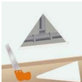
1. Con una sierra puntiaguda, corte la placa en forma de triángulo, y si ese ha sido el caso, subsane la avería.
