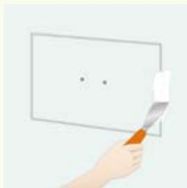
3. Emplastezca las juntas producidas y los tornillos, utilizando cinta de refuerzo y pasta para juntas **PLADUR®**.
