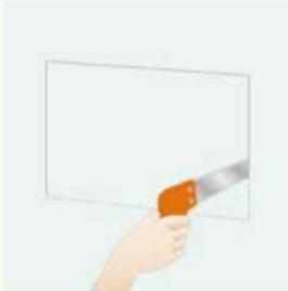
1. Con ayuda de una sierra de punta o de calar, abra una apertura en la pared de **PLADUR®**, de tamaño suficiente para colocar un taco o un listón de madera.
