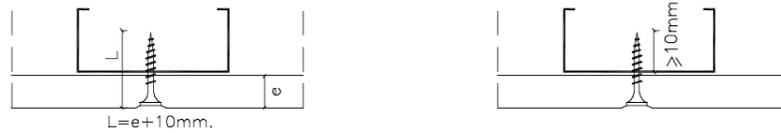
4.- A continuación se exponen los distintos tornillos a utilizar según el espesor de PYL a atornillar:
