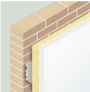
» **Trasdosado directo** corresponde a la unidad constructiva realizada, “pegando” directamente al muro o pilares una placa **PLADUR**®, que en caso de fachadas lleva incorporado material aislante para otorgarle las características térmicas precisas e impedir por tanto, la salida o entrada del calor.
