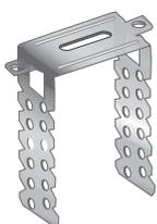
Pieza compuesta por una parte central reforzada, un taladro central para su fijación al forjado o muro soporte y dos alas laterales con taladros y perforaciones para facilitar el plegado y atornillado al Perfil T-47. La pieza se suministra plana y posteriormente se dobla para su instalación.
