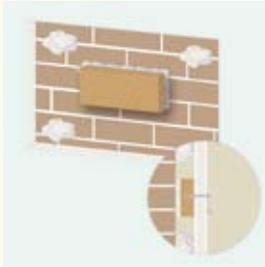
2. **Solución A.** Recíbalo al muro o incorpórelo dentro de él. Ahora, ya puede fijar la misma placa que cortó, atornillándola al taco de madera y colocando cuatro "pegotes" de pasta de agarre **PLADUR®** en las cuatro esquinas.
