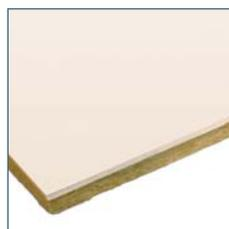
**Descripción** Paneles transformados obtenidos al incorporar en el dorso de una placa PLADUR® del tipo N, una plancha de lana de vidrio de 75 Kg/m<sup>3</sup> de diferentes espesores e incombustible.
