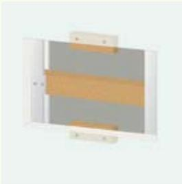
3. Coloque en las partes superior e inferior del hueco unas piezas de madera, atornillándolas a las placas.
