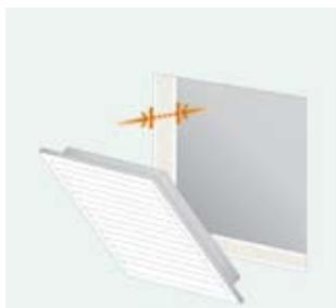
3. En el caso de los cuartos de baño, los conductos de ventilación van siempre cubiertos por una rejilla. Retírela y mida en el hueco el espesor del paramento.
