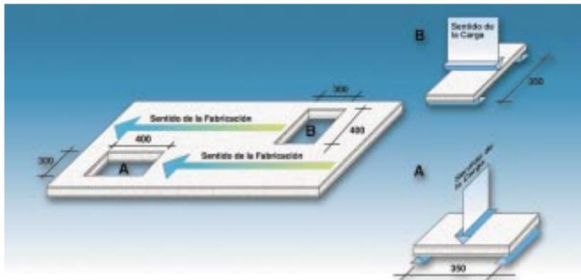
**Resistencia al Choque duro.**- La protección de las caras de su alma de yeso con las láminas de celulosa multihoja, confiere a la placa **PLADUR®**, una Resistencia al choque duro superior a la del guarnecido y enlucido tradicional de yeso.
