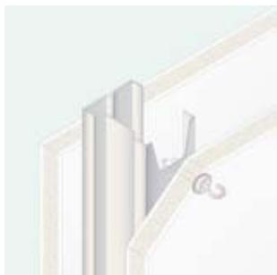
Deberán anclarse a la perfilería de los tabiques o reforzar con elementos resistentes. Le recomendamos que consulte con los servicios técnicos de **PLADUR®**. Para estos tipos de cargas suele instalarse un refuerzo en el interior del tabique durante el montaje de los sistemas **PLADUR®**.
