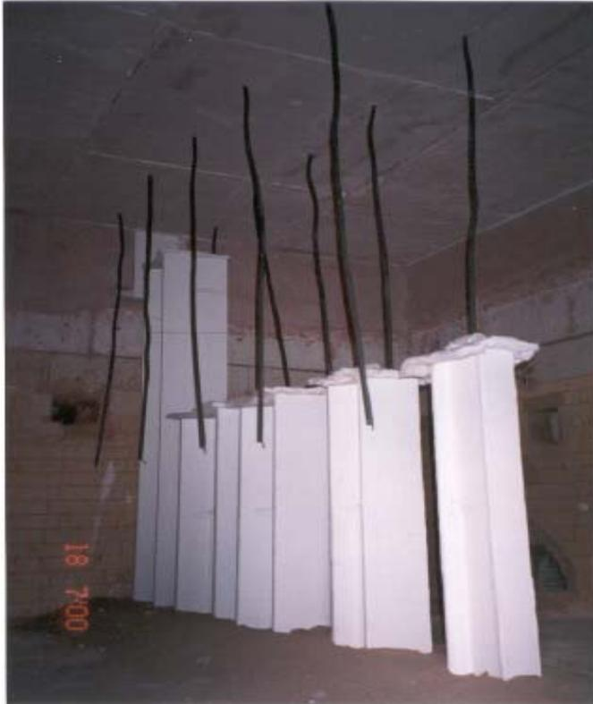
Preparación de perfiles en horno para realizar los ensayos. Mediante sonda determinamos la temperatura del acero.
