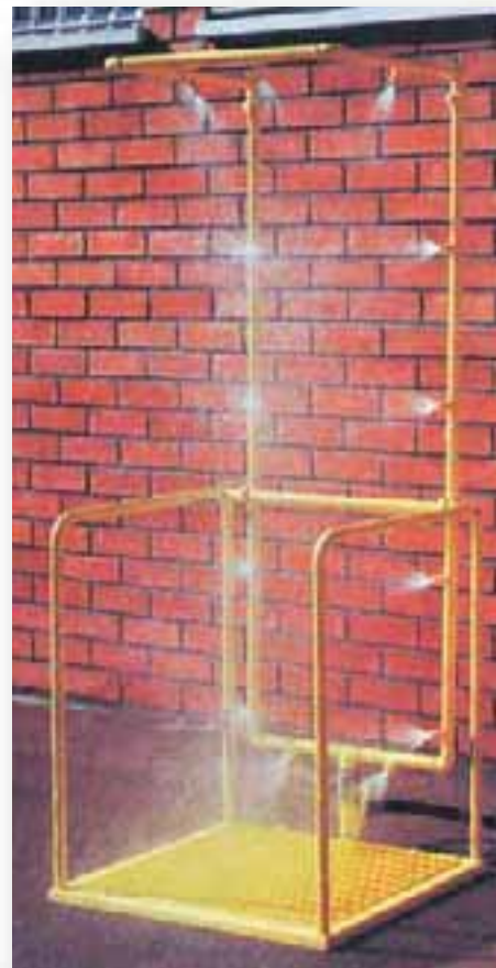
Cabina de descontaminación con rociadores múltiples. Funcionamiento automático al colocarse sobre la plataforma. La ducha comprende 14 rociadores para el lavado completo de todo el cuerpo.
