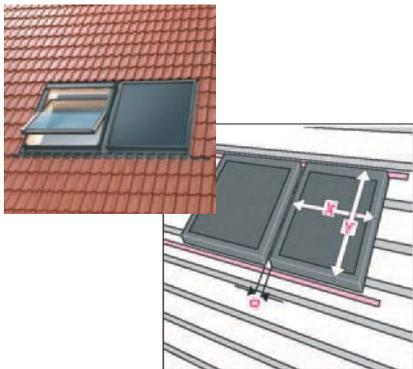
La puesta en obra de los captadores solares VELUX se realiza según el mismo criterio empleado para las ventanas de tejado VELUX. Su instalación se realiza atornillando los dos laterales del bastidor del captador sobre el material de apoyo de las tejas o pizarra. No precisa, por lo tanto, de estructuras auxiliares de soporte que puedan dañar el material de cubierta.
