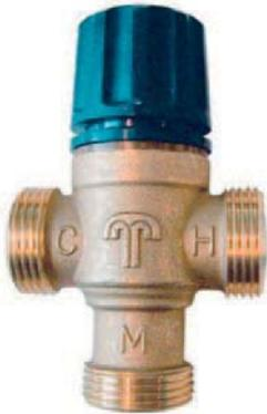
El mezclador termostático incluido en los equipos solares VELUX permite obtener una temperatura constante entre 35°C y 65°C. Para incrementar la temperatura del agua deberá presionar y girar hacia la derecha la tapa junto con el termostato. Una vez alcanzada la temperatura deseada se liberará la presión sobre la tapa. Deberá asegurarse que se ha fijado el termostato en la temperatura deseada.
