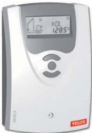
La centralita de control SCS C2 optimiza la eficiencia energética de la instalación controlando el caudal de la bomba del circuito primario según el diferencial de temperaturas entre impulsión y retorno de los colectores.
