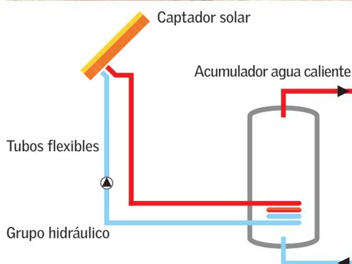
El equipo consta, básicamente, de cuatro elementos: captador/es, acumulador de A.C.S., tubos flexibles y grupo hidráulico.
