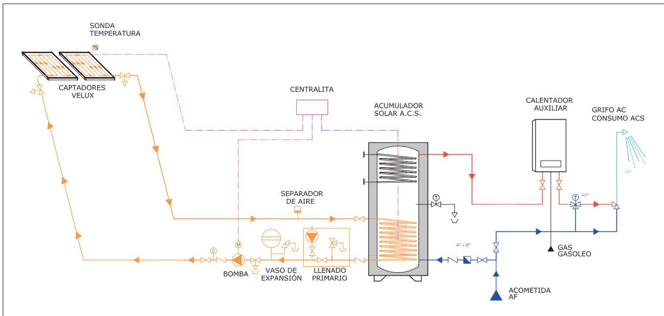
Esquema tipo instalación solar térmica para A.C.S.
