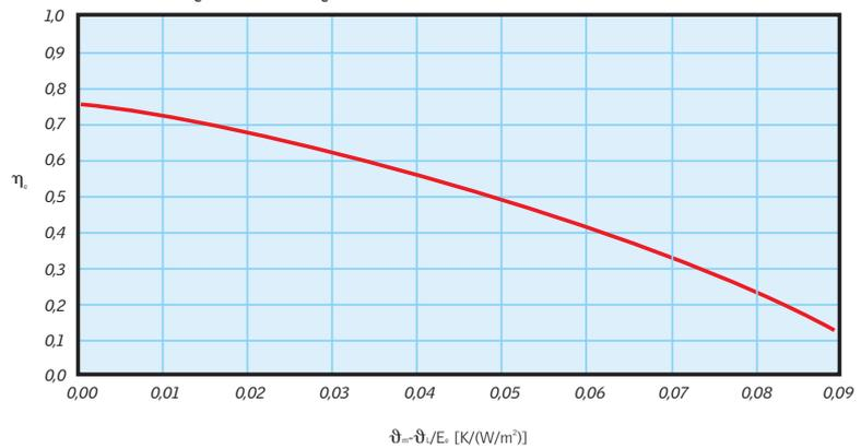
El rendimiento de un captador solar representa la cantidad de energía emitida por la radiación solar que es transformada en energía calorífica.
