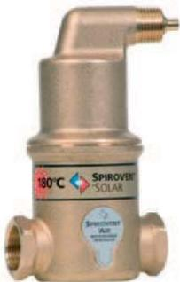
El desaireador automático de microburbujas para temperaturas de hasta 180°C, facilita la eliminación de las burbujas de aire contenidas en el fluido caloportador del circuito primario.
