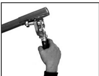
Con la ayuda de los cuchillos, situados en la extremidad de la pinza, separar la cubierta del cable.
