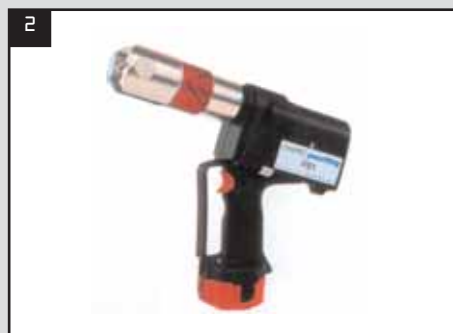
Herramienta eléctrica con acumulador para \varnothing de 12 a 54 mm.
