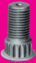
CONCAVIDAD AHUECADA EN ESPÁRRAGOS
